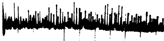
Рис. 8.2 Типичная временная зависимость интенсивности излучения первых твердотельных лазеров с непрерывной накачкой. Масштаб времени — 50 мкс/дел (согласно работе [3])
