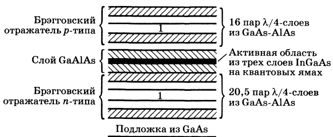
Рис. 9.34 Схематическое представление лазера с вертикальным резонатором и с нижней излучающей поверхностью. Самый верхний слой GaAs имеет толщину, равную половине длины волны, чтобы обеспечить согласование по фазе с металлическим контактом. (Согласно работе [52].)
